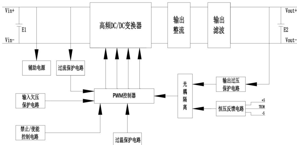
高频 DC/DC 使用双路差相交错，实现天然备份功能；变压器使用多层板绕线工艺，确保生产一致性和可靠性。
