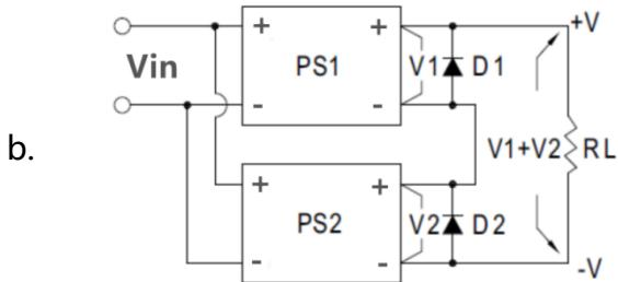
为了提升输出电压，输出电流不变，可按照左图 b 连接，由于 DD300-110S 系列输出内部没有阻断二极管，每台应该添加一个二极管，以防止启动时，单机被损坏，二极管的额定电压值应该大于  $V_1+V_2$  的值
