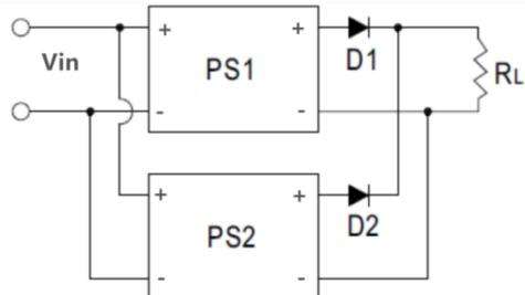
DD300-110S 系列没有内置并联电路, 它只能使用外部电路来实现冗余操作, 但不增加输出的额定电流。
