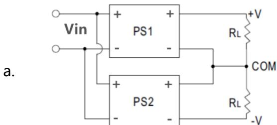
为了得到正负输出电压, 可以按照左图 a 连接
